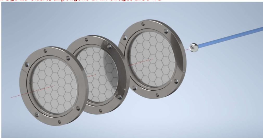
*Rappresentazione di un test di impatto di micrometeoriti su prototipi di filtri per X-IFU. Verranno utilizzati 5 filtri rappresentativi, di dimensioni ridotte rispetto a quelli da volo. La particella in figura non è in scala, verranno infatti usate particelle con diametro tra 100 nm e 10 µm (Credits Ugo Lo Cicero e Fabio D'Anca).*
