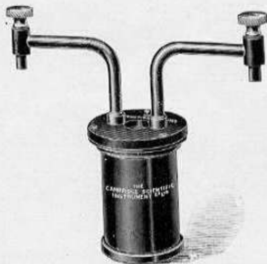
FIG. 82. — Etalon de résistance, modèle hermétiquement fermé.
