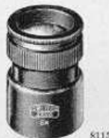
Fig. 36, \frac{1}{2} grand. nat. Loupe de mise au point 6 fois avec bagues de mise au point et de serrage
