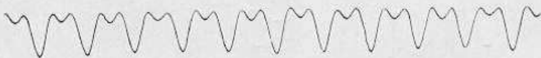
Fig. 5. Originalbild der durch eine Großgasmaschine verursachten Bodenschwingungen. Vergrößerung 12000 fach; Entfernung von der Maschine 400 m.
