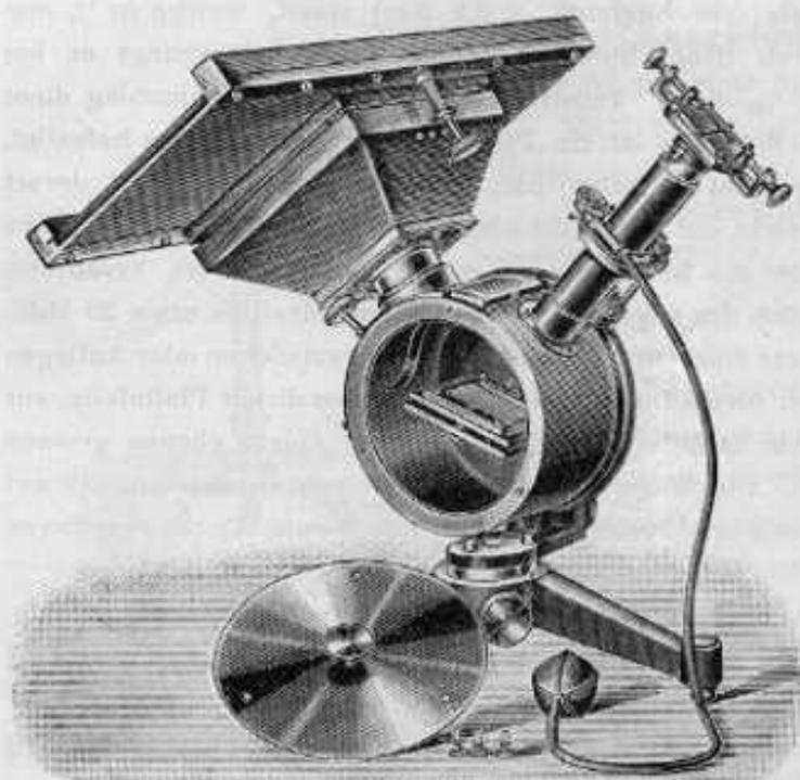
Das bei dem Spektrophograph verwendete Gitter ist ein Thorp's Transmission Diffractions Gitter mit ungefähr 600—680 Linien pro mm. Der Apparat ist für durchfallendes Licht gebaut. Jedoch liefern wir denselben auch, wenn es sich hauptsächlich um Aufnahme im ultravioletten Gebiet handelt, für reflektierendes Licht, die Glasobjektive werden dann durch Quarzlinse ersetzt.
