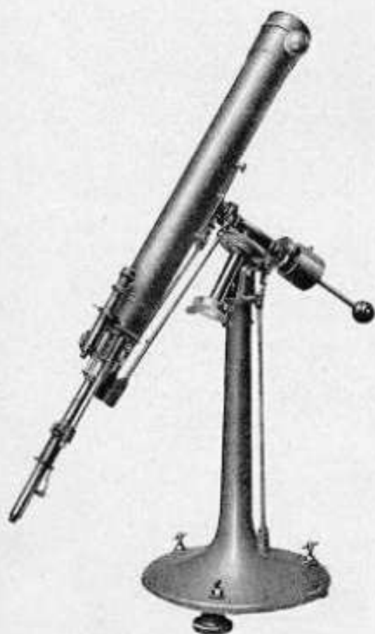
N. 14. Rifrattore equatoriale per studi astrofisici
