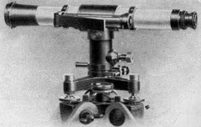
Nr. 715 und 716. N. I. K. Nivellier-Instrument mit drehbarem Fernrohr, Reversionslibelle, Kippschraube mit Trommel, abnehmbarem Dreifuß
