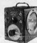
«Strobotac» General Radio Mod. 631 per misure di velocità
