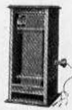
Shunt Tinsley antinduttivo e anticapacitivo
