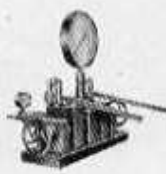
Pressa Kipp & Zonen per pressioni fino a 10.000 atmosfere
