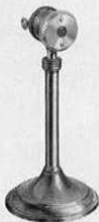
Fig. 9 Pila termoelettrica tipo „micro“ con fenditura regolabile
