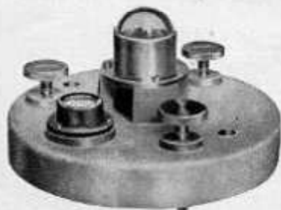
Fig. 12 Pila termoelettrica solarimettrica su zoccolo per installazione all'esterno
