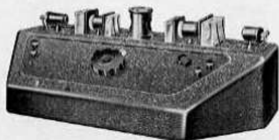
Fig. 15 Colorimetro e Nefelometro di Moll per luce bianca, tipo A
