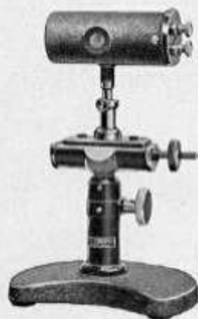
Fig. 8 Coppia termoelettrica nel vuoto, su supporto
