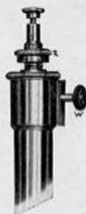
Fig. 3. Tête de torsion du galvanomètre Moll à haute sensibilité en volts.
